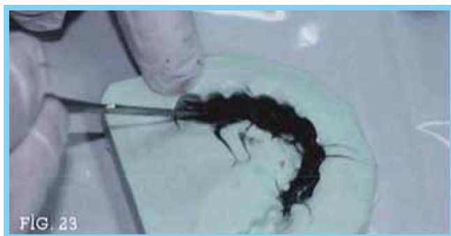
Fig. 23,24 Rellenado de la fibra esparcida en el interior del contra-estampado.
