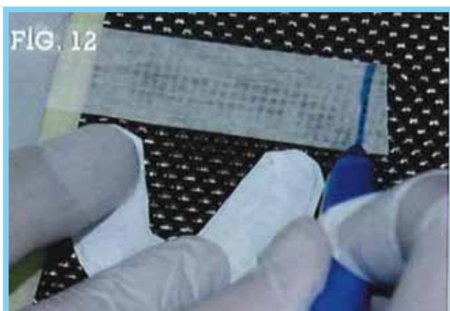
Fig. 12 Marcamos las dimensiones de la plantilla sobre la hoja de fibra de carbono.
