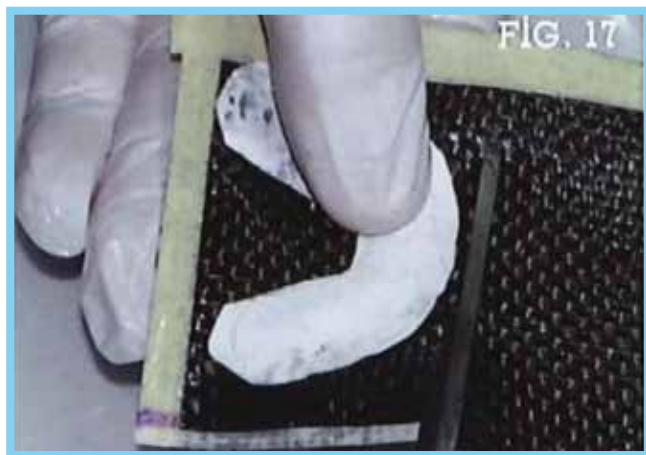
Fig. 17, 18 Cortamos los trozos de fibra de carbono uno a uno
