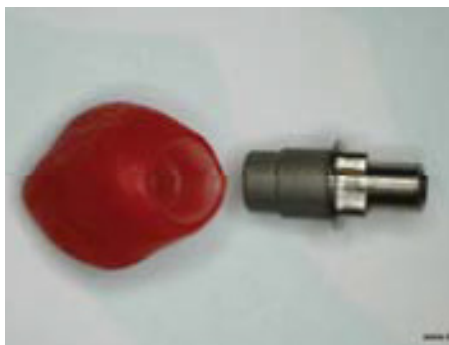
IMG20. Modelado de estructuras sobre el plástico de la interfase ideal para escaneado por palpación tipo pantógrafo.
