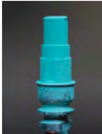
IMG6. Aplicación de spray opaco para la lectura del escaner.
