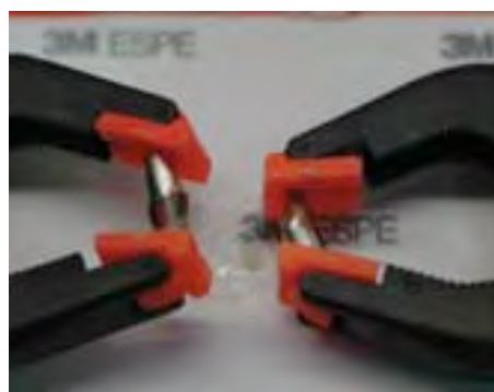
IMG24. Las interfases bajo presión mientras fragua el cemento.
