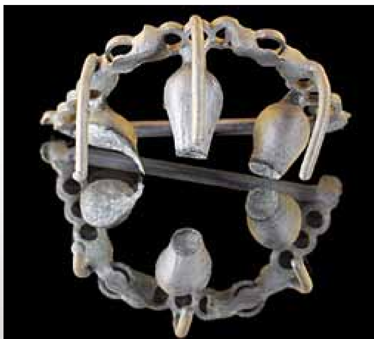
Fig. 20 Estructura después de la fusión
