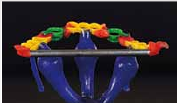
Fig. 18b Estructura con bebederos antes de poner el revestimiento
